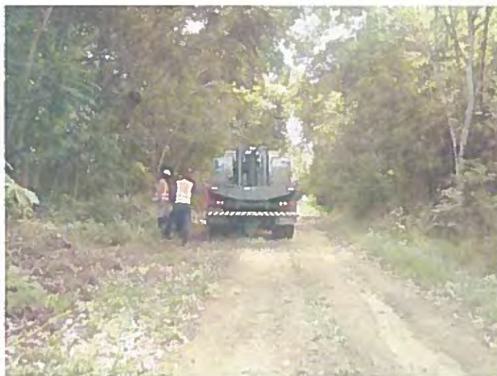
FIGURA 11 – Imagem do levantamento na linha 04 ao longo de uma estrada que termina na estação de bombas situada no pé da barragem. Podemos ver a fonte AWD AF-450, já com a plataforma acoplada ao solo e pronta para executar um disparo.
