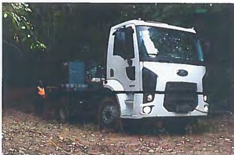
FIGURA 06 – Caminhão Ford 1717 com a fonte sísmica AWD, modelo AF450, acoplada em sua carroceria. Levantamento na Linha 01, situada na estrada próxima ao Sinkhole, onde pode-se ver dois geofones (pontos vermelhos), separados de 5 m, acoplados na estrada. Este levantamento gerou a seção sísmica AWD-01.
