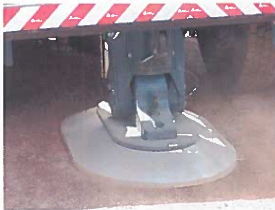
FIGURA 7 – Vista da placa metálica acoplada ao solo, sob o peso do sistema AWD mais a carroceria do caminhão, para que a placa não pule ao ser atingida pelo embolo de aço que vai cair em movimento acelerado. Este forte acoplamento com o solo evita que a placa pule e ocorra a geração de Ghost.
