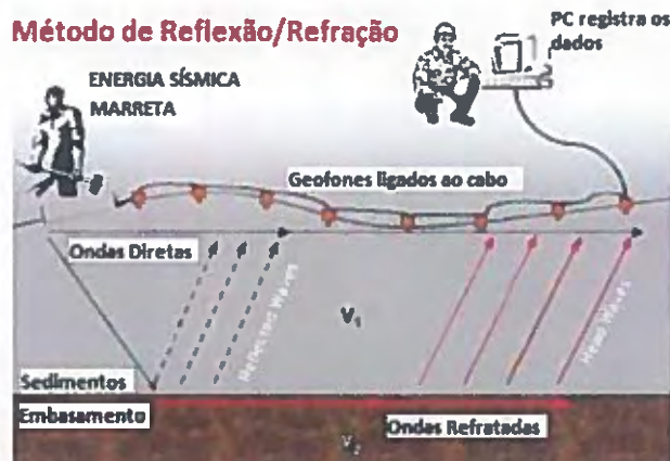
FIGURA 04 – Diagrama mostrando os equipamentos e componentes integrados na aquisição de dados sísmicos: geofones interligados a um cabo, fonte (marreta) e computador para armazenamento dos dados.
