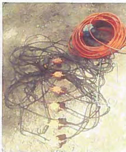
FIGURA 24 – Arranjo de seis (6) geofones para detectar os sinais refletidos provenientes da subsuperfície e gerar um único traço sísmico.
