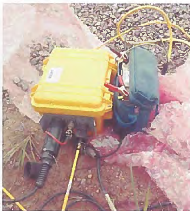
FIGURA 05 – Módulo do sismógrafo geode, onde pode-se ver as suas conexões com o cabo dos geofones (preto), o do trigger (vermelho) e o de conexão do outro módulo (amarelo); e ainda, o outro cabo amarelo que (lado oposto) que alimenta o sistema. Observe as pontas de jacaré plugando na bateria (capa azul).
