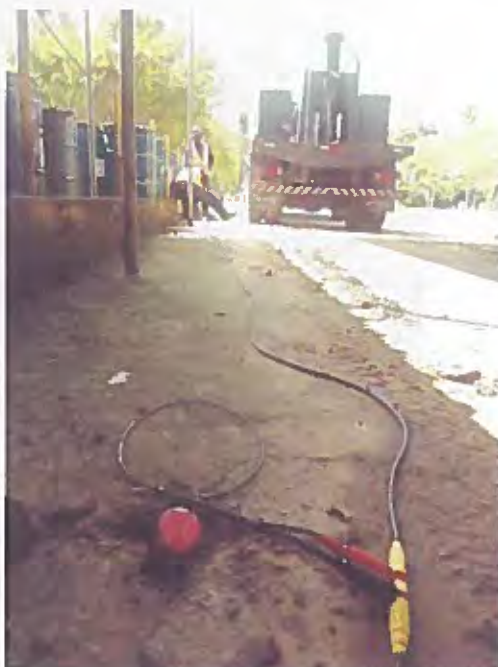
FIGURA 10 – Imagem do levantamento na linha 03 em sua porção inicial, onde pode-se ver dois dos quarenta e seis (46) geofones instalados em linha reta atravessando a área administrativa da DOW, bem como a fonte AWD AF-450 em posição para executar o terceiro disparo.
