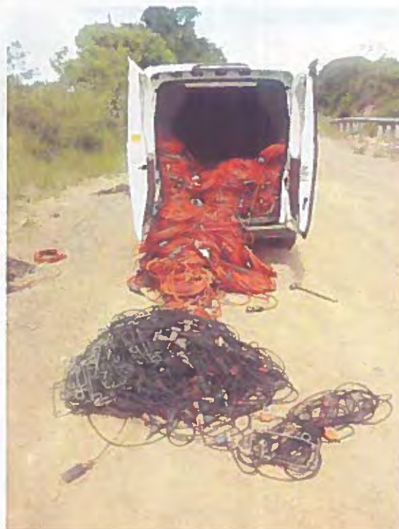
FIGURA 27 – Conjunto de cabos e geofones necessários ao levantamento da seção AWD 05 com o posicionamento de seis (6) geofones em cada ponto de registro dos dados.
